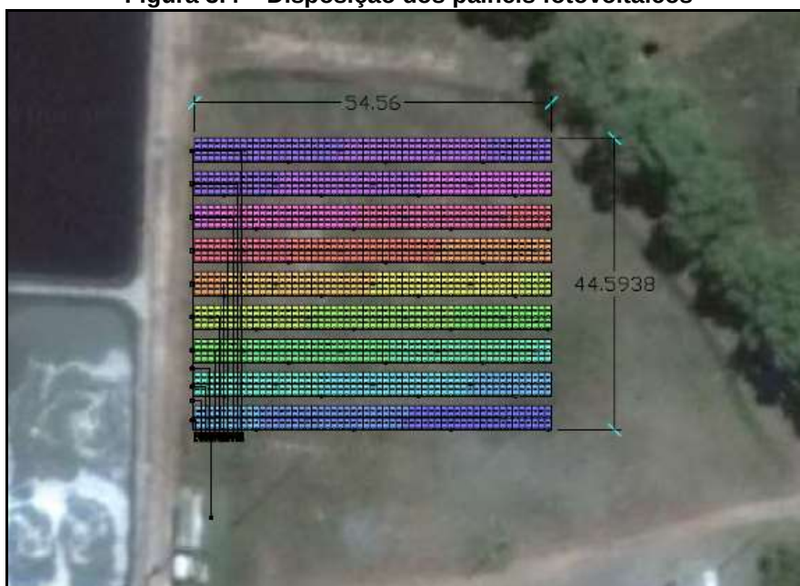
Figura 3.4 – Disposição dos painéis fotovoltaicos
