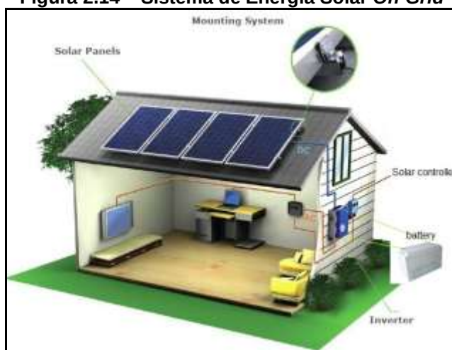
Figura 2.14 – Sistema de Energia Solar Off Grid
